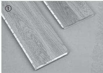
① Linkes Element. Rechtes Element. Zur Fischgrätverlegung werden linke und rechte Elemente benötigt. Linkes Element: Feder stirnseitig oben und an linker Längskante. Rechtes Element: Feder stirnseitig oben und an rechter Längskante.
