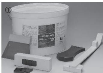
① Verlegewerkzeug: Spezial-Schlagklotz, Abstandskeile, Profi-Montageeisen, Elastikleber, Zahnpachtel D, Bleistift, Meterstab
